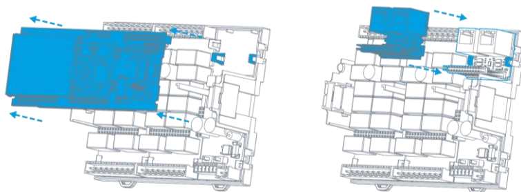
Рис. 65 – Снятие процессорной платы и установка платы сетевого модуля
